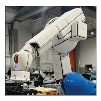
Durch AIRSKIN können Roboter als maschinelle Assistenten direkt neben menschlichen Mitarbeitenden eingesetzt werden, da sie bei kleinsten Berührungen sofort gestoppt werden.
