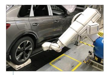
Die druckempfindliche AIRSKIN wird in Form von einzelnen Pads magnetisch an verschiedenste Industrieroboter angebracht.
